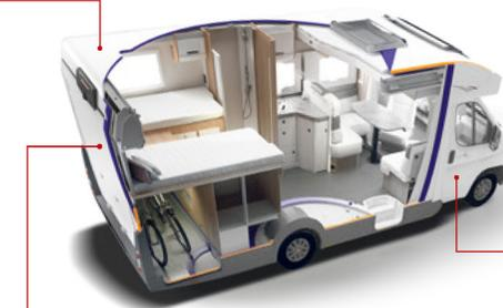
**SEITENWÄNDE. Hagelfester GFK außen.** Interne Struktur aus wasserfestem PS-Material. Der umlaufende Schutz aus hochdichtem Kunststoffmaterial verhindert jeglichen Kontakt zwischen innen und außen und verhindert so das Eindringen von Wasser in die Wände. **Innenwände aus Glasfaser**, beständig gegen Feuchtigkeit und ohne Wärmebrücken, die zumeist die Ursache für Kondensation oder Wärmeverlust sind.
